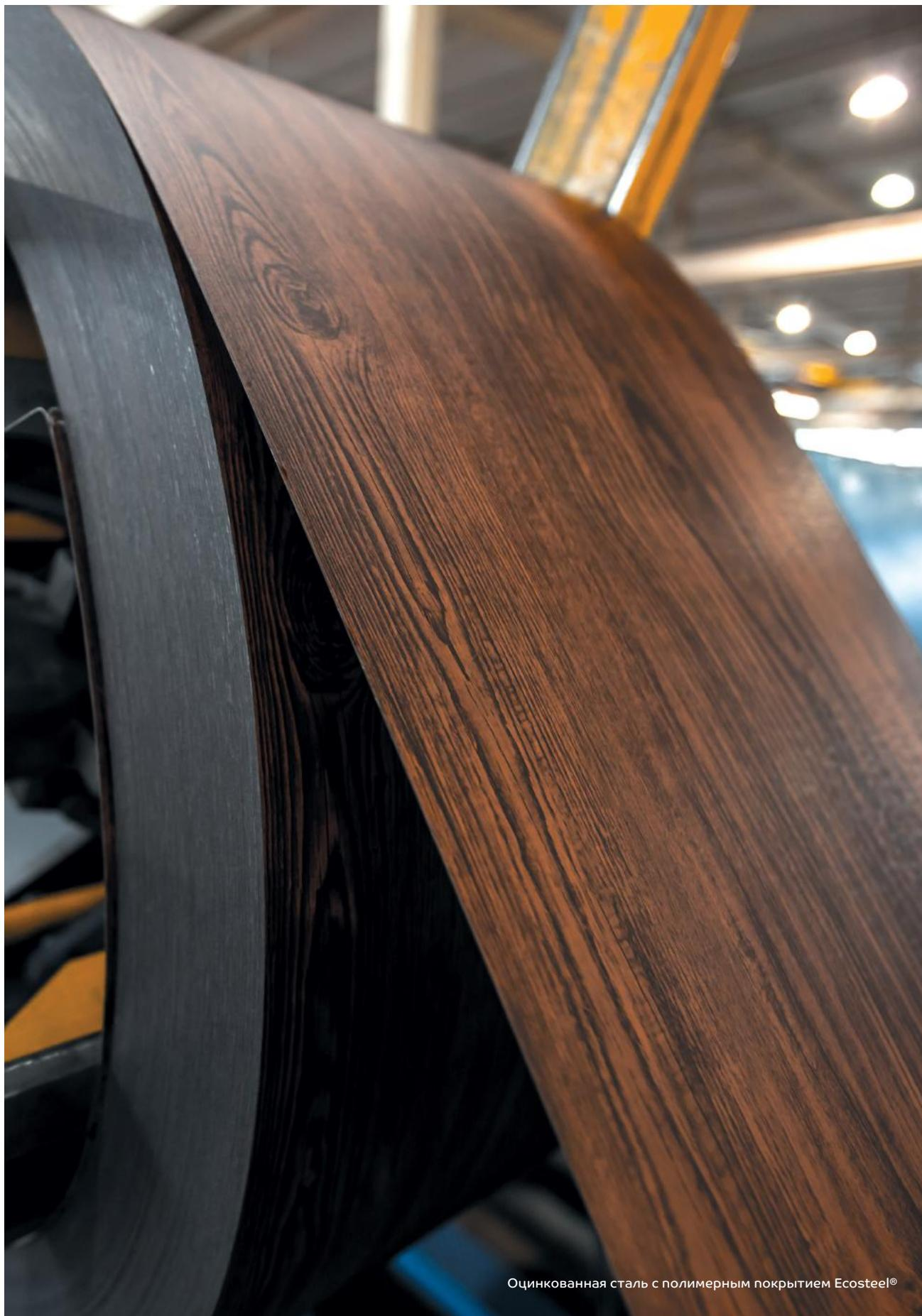
Оцинкованная сталь с полимерным покрытием Ecosteel®
