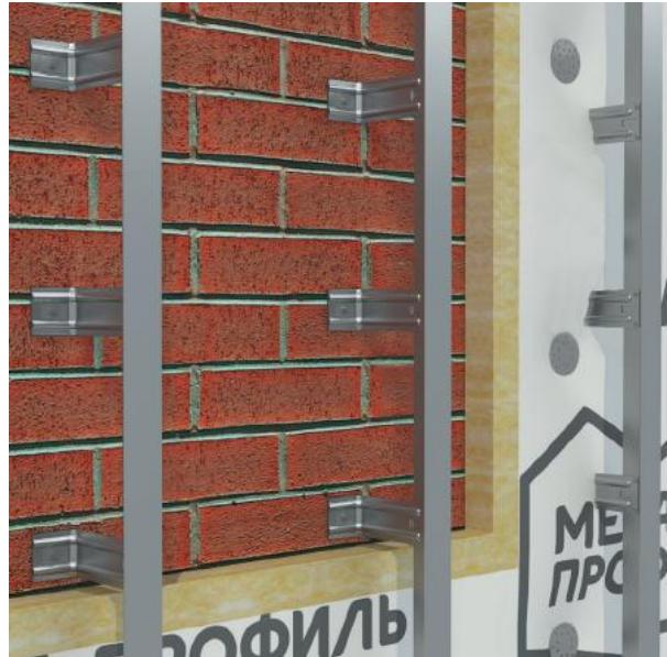
Бюджетный вариант системы стального каркаса для малоэтажного строительства. Предназначен для крепления вентилируемых фасадов из сайдинга и профилированного листа.
